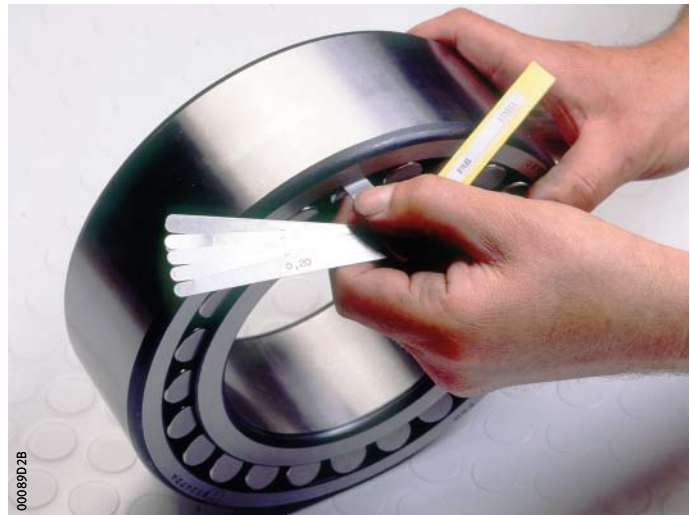
Figura 7 Medición del juego radial mediante galgas de espesor
