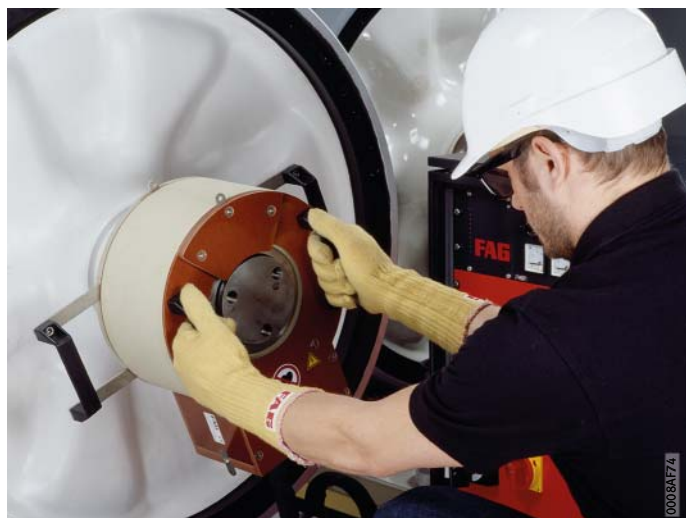
Figura 11 Desmontaje de los anillos interiores de rodamientos de ruedas (vehículos sobre raíles) con inductor fijo
