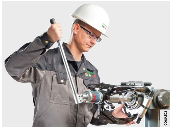
Figura 1 Desmontaje mediante dispositivos de extracción
