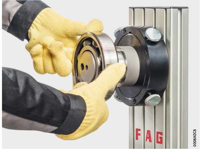
Figura 14 Montaje de las piezas calientes del rodamiento
