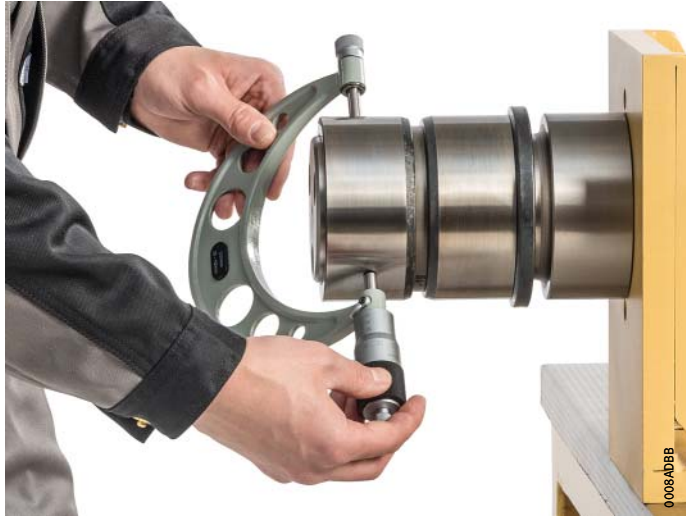
Figura 3 Medir la expansión mediante un micrómetro exterior
