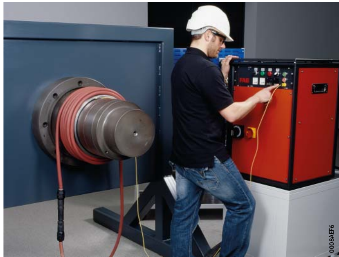
Figura 10 Desmontaje de anillos interiores mediante inductores flexibles
